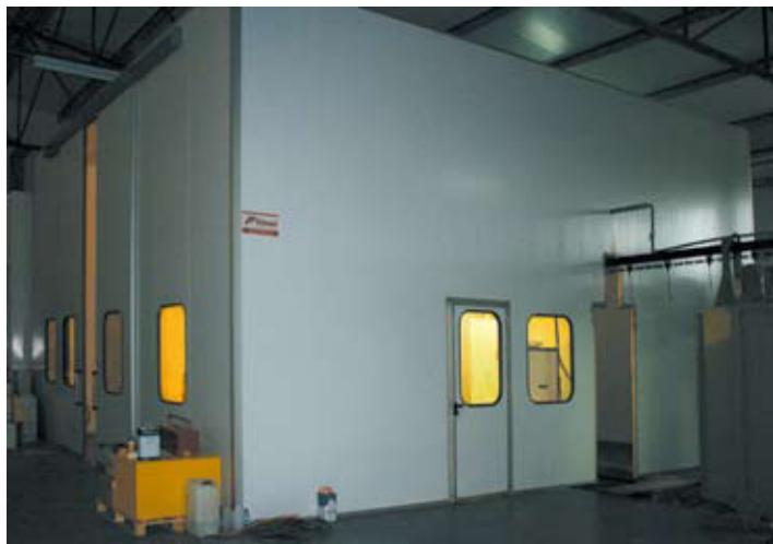
5 - Para evitar contaminaciones, la cabina se ha instalado en una zona limpia.
