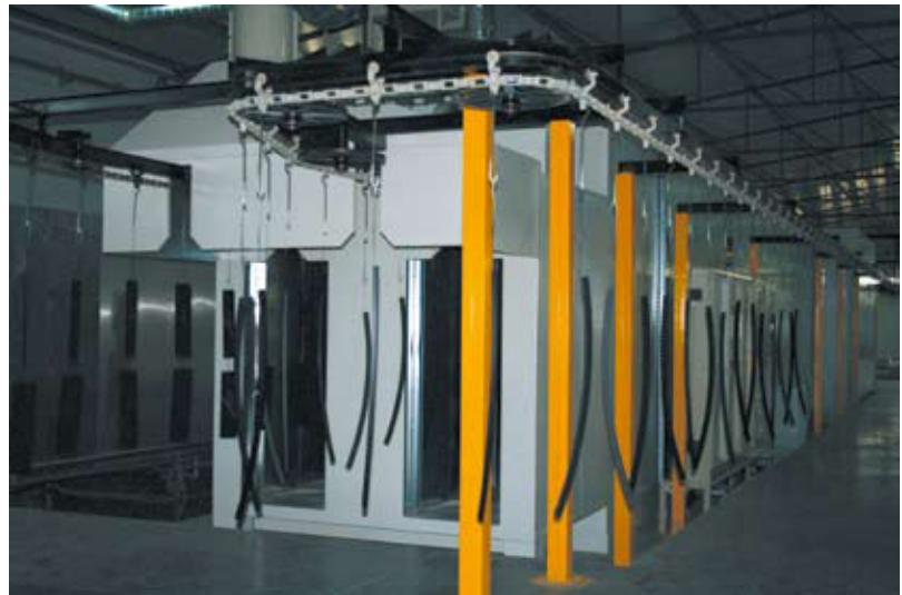
**10 - Entrada y salida de las piezas en el horno de polimerizacion.**
