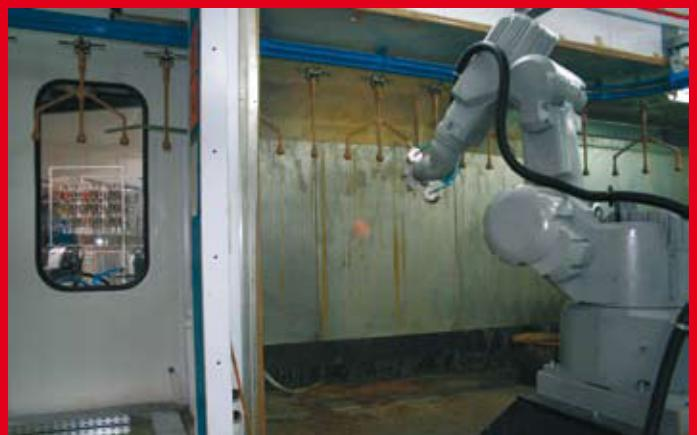
3 y 4 - El robot lleva un sensor laser que reconoce las piezas (en la segunda foto, se nota la luz roja del laser).
