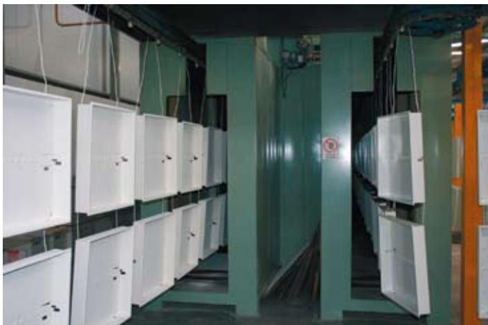
curamos não passar frequentemente de um ao outro, mas quando temos que o fazer, em 20 - 25 min a cabine fica pronta para voltar a funcionar. O sistema permite-nos desfrutar o pó em cerca de 99%, da cabine não sai nada, o que nos permite trabalhar num ambiente muito limpo.
