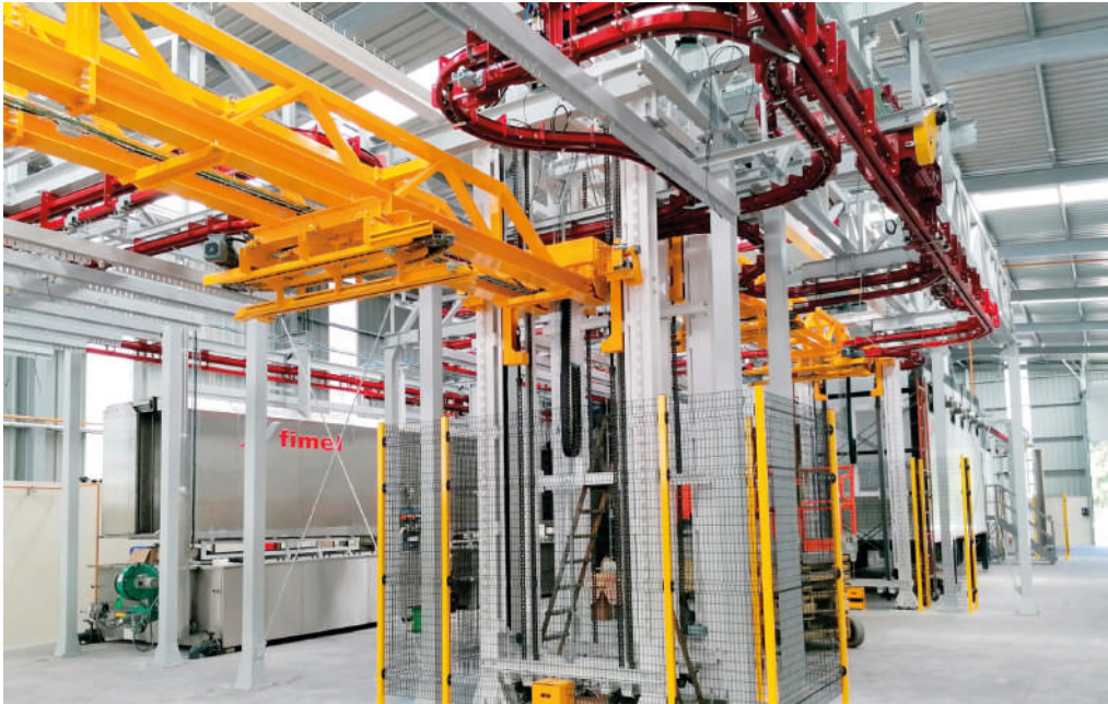
18-19 – Miranda Bike Parts, el mayor fabricante europeo de componentes de transmisión para bicicletas, pinta sus piezas utilizando una línea de pintura en polvo altamente automatizada de Fime!
